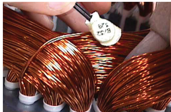
Figura 7.6 - Instalación del protector térmico bimetálico.
