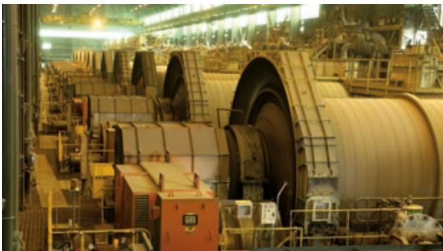
Codelco Teniente Repotenciamiento Molinos Bolas - Motor sincronico de alta polaridad con acople neumático
